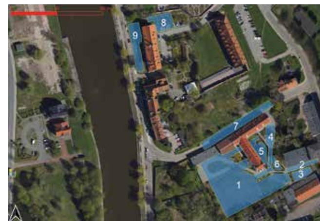
Ilustracja 15. Poligony pomiarów georadarowych, badania w 2022 roku – w obrębie zamku konwentualnego i na przypuszczalnym podzamczu południowym. Opracował: F. Welc.
