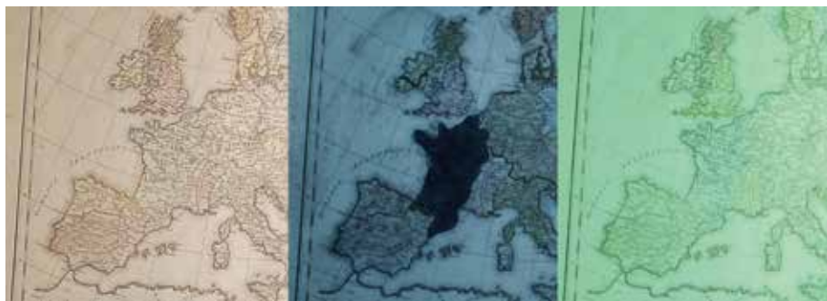
Fot. 8. Fragment mapy obrazującej sytuację w roku 900. Od lewej: A - obraz w świetle VIS, B- obraz w świetle UV (widoczne silne wygaszenie fluorescencji przez pigment miedziowy (teren Francji) i żółcienie żelazowe (kontury), C - obraz w technice fałszywych kolorów (zielony pigment miedziowy ma zmienioną chromatykę na błękit z podtonami fioletu, czerwony cynober ma zmienioną chromatykę na kolor żółty) (autor fot. Adam Cupa)
