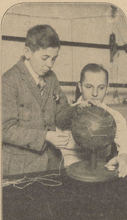
Psychotechnische Eignungsprüfung. Apparat zur Feststellung der Geschicklichkeit. (G. Pahl.)
