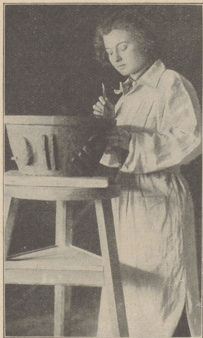
Abb. 2. Das mit der Hand aufgebaute Gefäß wird mit dem Modellierholz weiter bearbeitet, um Feinheiten herauszuholen.
