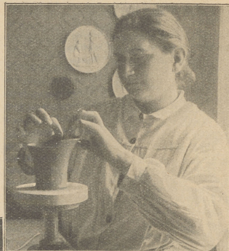
Abb. 3 (rechts): Entstehung eines Gefäßes im freien Auf- bau, einer ur- alten Töpfer- technik.
