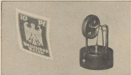
Der Elektromotor des Wiener Philipp Rother, der kleinste der Welt; Betrieb durch eine Taschenlampenbatterie; 1600 Umdrehungen in der Minute; Leistung: 0,08 PS.
