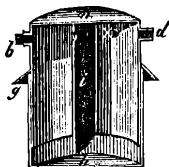
stellt man auf einen Untersatz, welcher bei *l* ein Loch hat und vermittelst Stellschrauben so gestellt werden kann, dass das Gefäls gut darauf steht. In dem Deckel ist noch eine Scheidewand *i* angebracht, um die Erkaltung der hineintretenden Substanzen zu beschleunigen. In die Vorlage gießt man destillirtes Steinöl, bis ungefähr ein Drittel damit gefüllt ist. Die Länge der Flasche beträgt 11, die Höhe 4 Zoll; nach diesem Maassstabe sind die übrigen Theile des Apparats gezeichnet.
