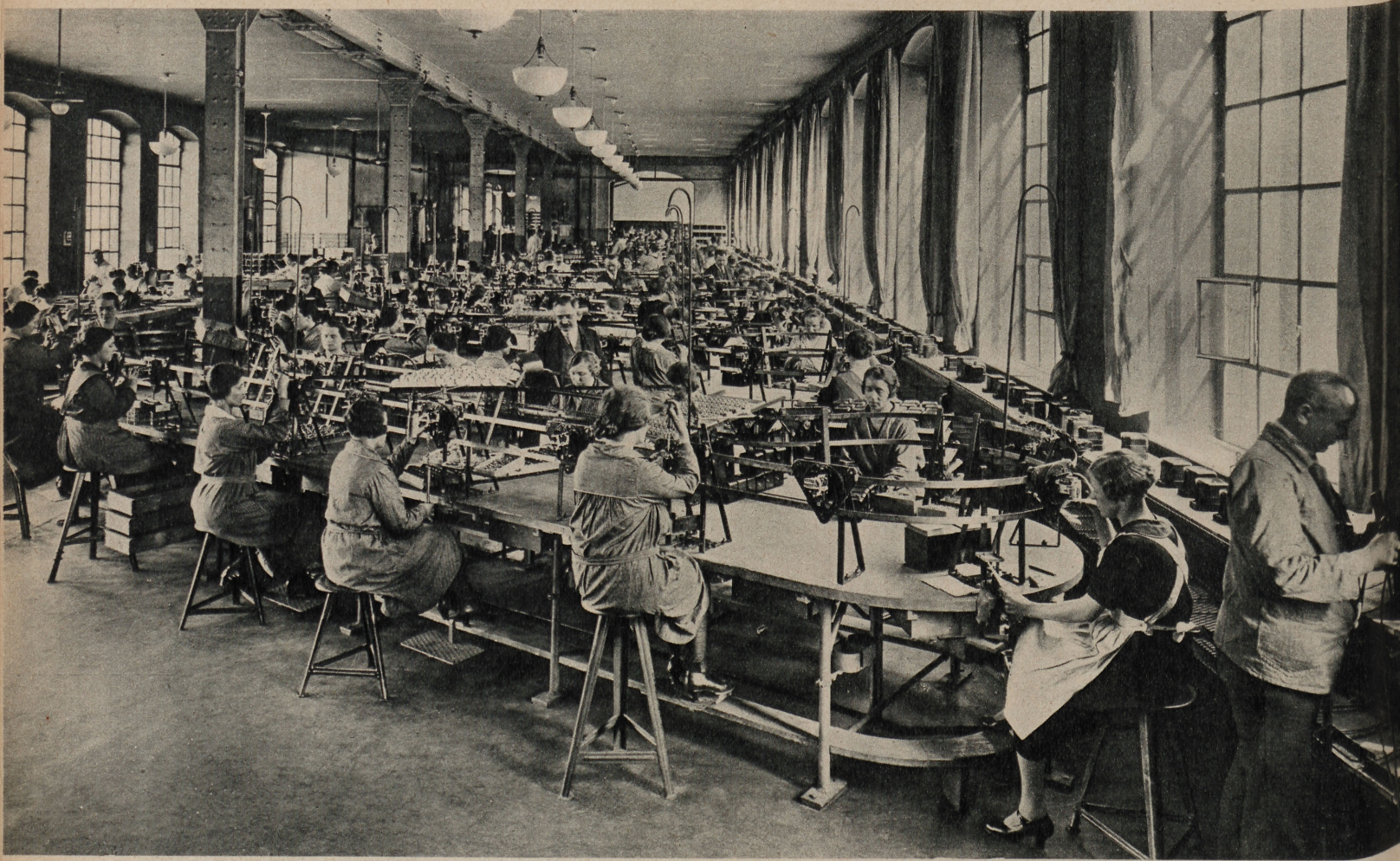
Arbeit am laufenden Band: Montagesaal für Elektrizitätszähler, in dem nur Frauen arbeiten
