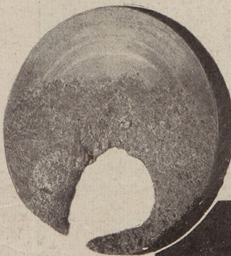
Wirkungen von schnellen Elektronen auf Metalle (Aluminium). Die Strahlen verursachen kraterähnliche Löcher und Schmelzungen des Materials
