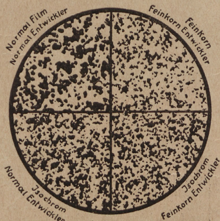
Das mikroskopische Bild des entwickelten Silberkorns bei verschiedenem Negativmaterial und verschiedenen Entwicklern
