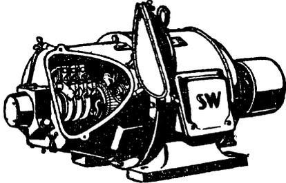
Kompensierter Motor für 7,5 PS, Drehzahl: 1500, in tropf-
