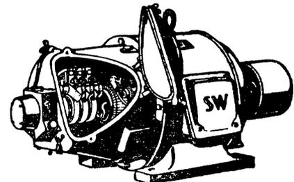
Kompensierter Motor für 7,5 PS, Drehzahl: 1500, in tropf-
