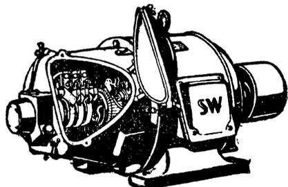
Kompensierter Motor für 7,5 PS. Drehzahl: 1500, in tropf-wassersicherer Ausführung
