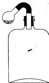
Verbrennen von Arsen-, Antimon-, Wismutpulver in Chlorgas.
