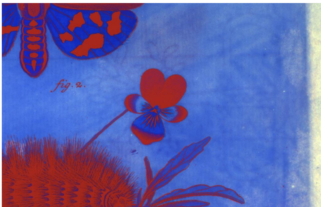
Fot. 3. Karta B (wycinek obrazu zapisanego w pliku B PCA2 487_red 372.tif)– obraz w barwach fałszywych, złożony z kanałów: PCA2, fluorescencji w 487 nm z filtrem czerwonym i reflektografii w 372 nm. Widoczne detale sita czerpalnego i filigran.
