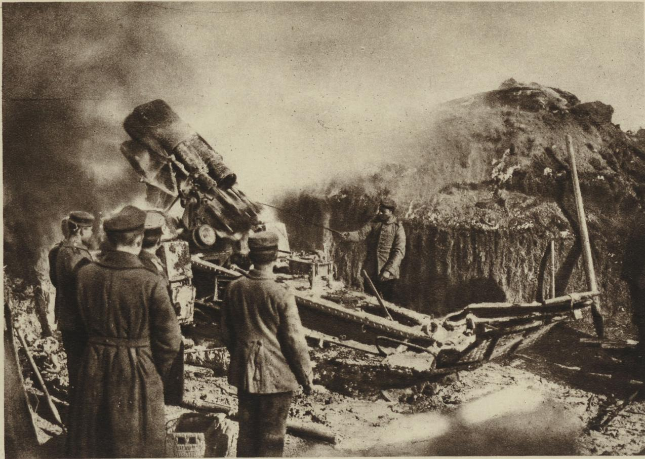
In einer Mörserstellung an der Serehfront. Der Abschuss. Der Mörser ist ein Steilfeuergeschütz und wird insbesondere gegen stark gedeckte Ziele eingesetzt.
