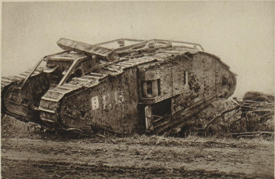
Rautenförmiger englischer Tank. Der Tank ist ein Produkt des Grabenkrieges. Er sollte möglichst schnell und möglichst sicher eine entsprechende Gefechtskraft an und über den feindlichen Graben bringen. Als Kriegswaffe erstmals in der Sommieszlacht (49 Tanks) am 15. September 1916 zwischen Pozières und dem Lenzwalde eingesetzt, tritt er in größeren Massen bei den Offensiven 1917 bei Arras und namentlich bei Cambrai auf.
