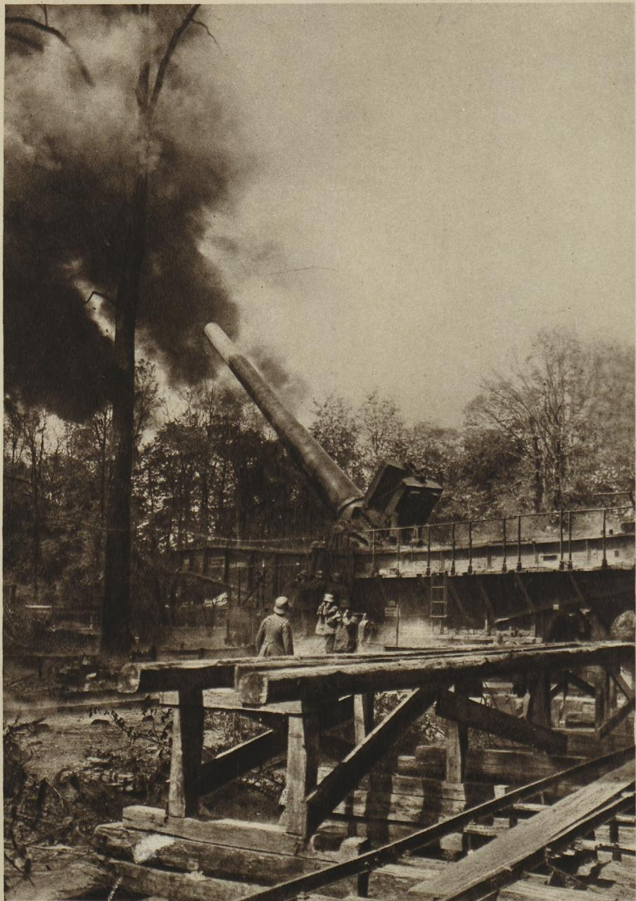
Der Abschuß eines 38 cm Geschützes. Die Erhöhungsmöglichkeit eines derartigen Geschützrohres betrug 45 Grad und darüber. Das umliegende Gelände wurde in künstlichen Nebel gehüllt. Die starke Rauchentwicklung beim Abschuß würde sonst dem Gegner Rückschlüsse auf den Standort des Geschützes ermöglicht haben.
