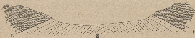
Fig. 37. Querschnitt des Firth of Tay-Thales. S. unterer alter rother Sandstein t. Trapp.
