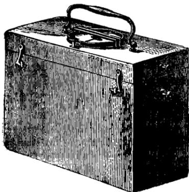
Figur 1 zeigt uns das Außere des Galvanometers, bestehend in einem kleiner, leicht transportablen Mahagonikästchen, dessen Deckel durch 2 Haken geschlossen ist. Seitlich bemerken wir 2 Klemmschrauben, welche zur Befestigung der Probir-Kupferdrahtleitung dienen; oben eine Boussole, die mit isolirtem Kupferdraht umwickelt ist und deren Nadel durch eine Schraube leicht zu arretiren d. h. in Ruhe zu versehen ist.
