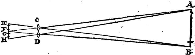
ACF, BCE, ADH und BDG enthalten sind, die durch die Enden des Gegenstandes und durch die Mitten der Gläser gehen. Gesezt die Gläser werden zusammengerückt, bis daß beide Bilder sich berühren, so daß die Punkte F und G einander decken, so giebt der Winkel CFD oder CGD den scheinbaren Durchmesser AFB des
