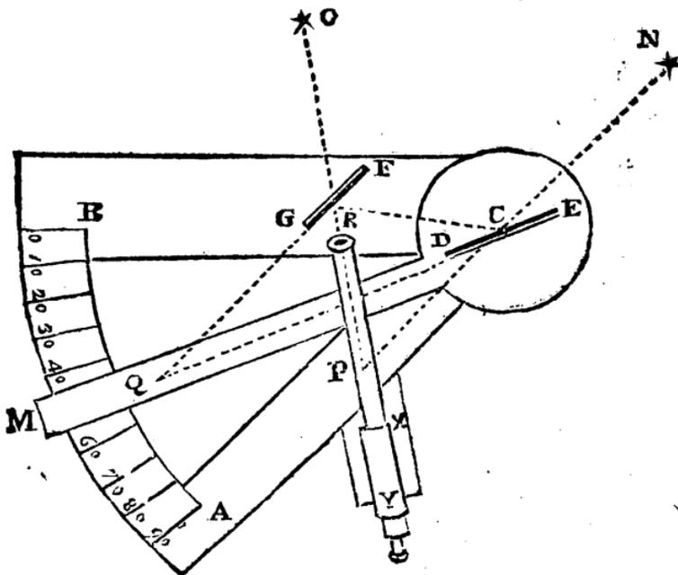
wie in den beiden vorhergehenden. Man beweiset auch ganz wie bei §. 15 daß  $\angle NPO = 2 \angle RQC$ . Wenn nun der Spiegel DE so gestellet wird, daß er mit GF parallel sei, wenn MC auf BC lieget, so nimmt der Winkel RQC mit dem Winkel MCB zu, und beide sind immer gleich. Also ist  $\angle NPO = 2 \angle MCB$ ; deswegen
