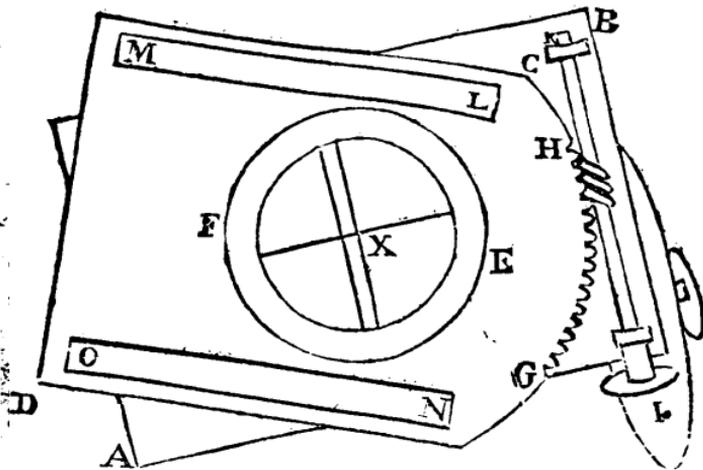
Platte CD wird, wie man bald sehen wird, am Fernrohr fest gemacht, und vermöge des Ringes EF läßt sich die Platte AB um den Mittelpunkt X herumdrehen, jedoch braucht diese Bewegung nur klein zu sein. Um sie zu erhalten, trägt die Platte AB eine Schraube ohne Ende Ik, welche in die Zähne GH der Platte CD eingreift.
