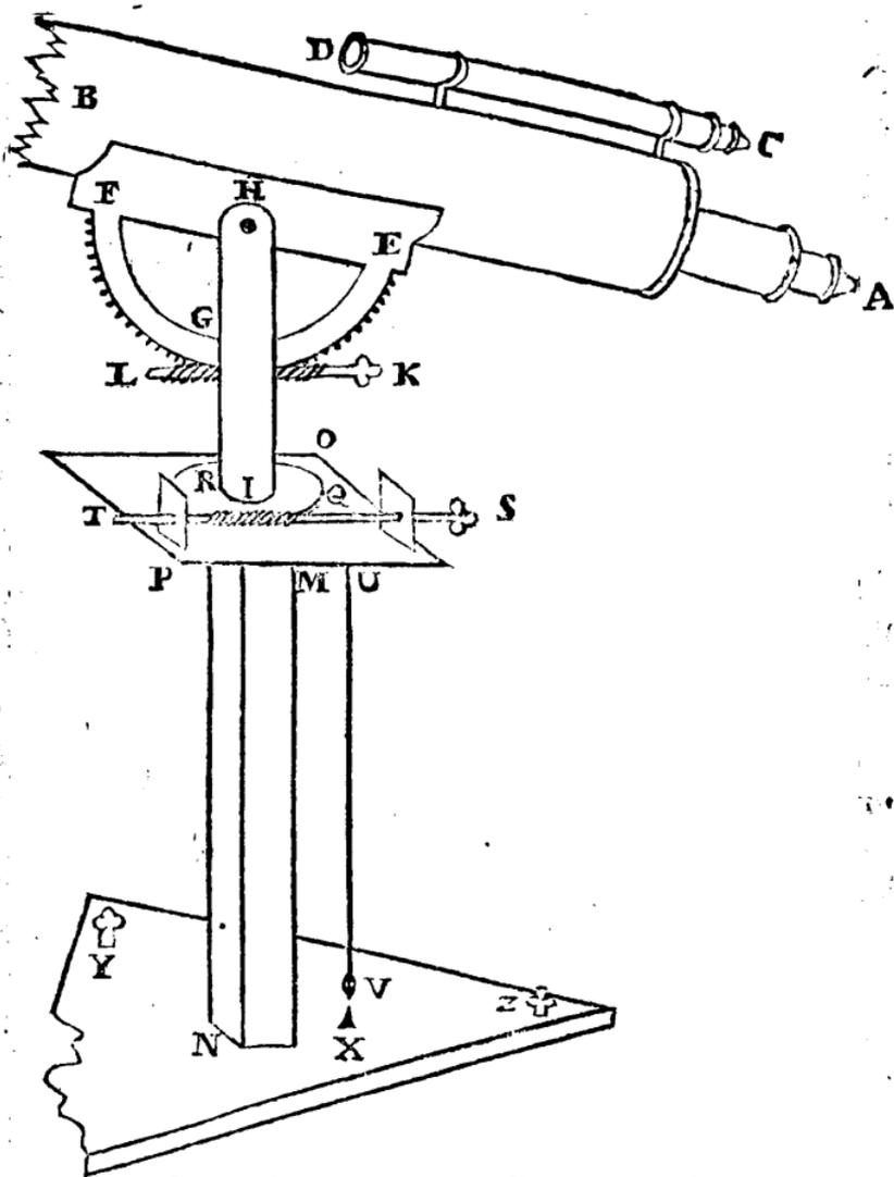
Bewegung sicherer zu machen, ist am großen Tubus ein halber Ring EGF befestiget, der in einem Kloben HI läuft. Zu noch mehrerer Genauigkeit kann der Rand des Ringes mit Zähnen versehen werden, so daß man ihn mittelst einer Schraube ohne Ende KL drehen könne. Weil aber die durch die Schraube verursachte Bewegung lang:
