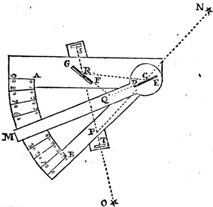
S und T sind zwei Dioptern, die so eingerichtet sind, daß man mit dem Auge hinter S den Gegenstand O durch T sehen könne. Der Spiegel FG stehet so, daß ein aus C auf seine Mitte R fallender Stral nach S hin reflektiret wird, das heißt, so daß  $\angle CRF = \angle GRS$ . Der Spiegel DE wird so gestellet, daß er gegen FG senkrecht stehe, wenn MC auf BC lieget; so ist allemal der Winkel
