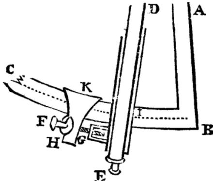
Es sei ABC ein Stück von einem Mauerquadranten oder einem andern ähnlichen Instrumente; DE sei ein Stück des beweglichen Lineals und des daran befestigten Fernrohrs. Man bringe am Limbus ein Stück HK an, welches umgebogen sei, den Limbus von beiden Seiten umfasse, und hinten vermöge einer Druckschraube am Limbus festgehalten werden könne. Durch das Stück HK geht eine Richtschraube FG, welche bei G in eine Mut-
