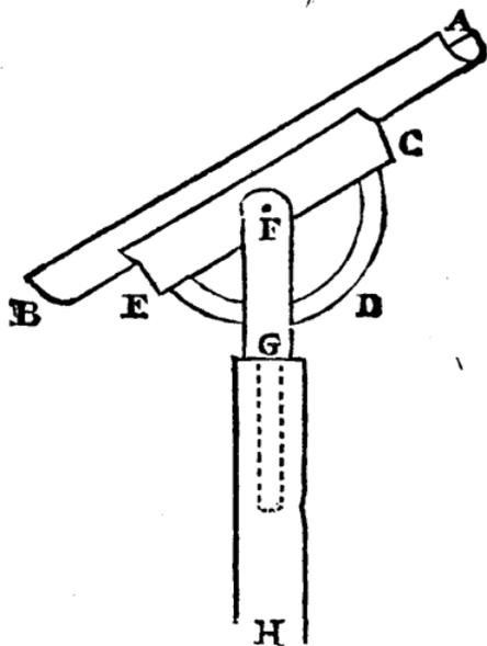
ruhet, kann durch Riemen oder auf irgend eine andere Art daran befestiget werden. Mit dem Troge ist der halbe Ring CDE verbunden, welcher die vertikale Bewegung giebt. Der Kloben FG, der sich mittelst eines Zapfens im Baume GH drehet, giebt die horizontale Bewegung.
