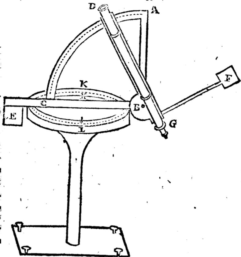
ABC ist ein vertikaler Quadrant; DG ist ein Lineal, welches sich bei B um den Mittelpunkt des Quadranten herum drehen läßt, so daß der eine Rand DB im Radius liege, welches vermittlest eines bei B aus dem Lineal vorkommenden halben Kreises erhalten wird. Auf dem Lineal
