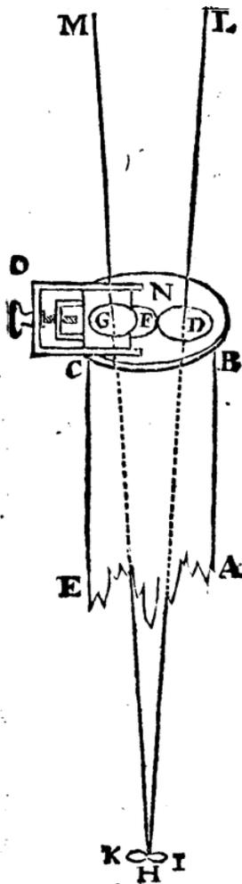
Diesem Grundsatz zufolge sei ABCE das dem Gegenstande zugekehrte Ende eines Fernrohres. Anstatt des gewöhnlichen Objektivglases, bedecke man das Ende mit einer Platte BC. In D mache man eine Oeffnung, und befestige darauf das eine Objektivglas. Neben dabei mache man eine länglichte Oeffnung F. Ueber dieser
