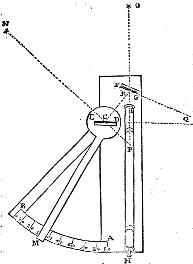
bei H hält, abgewendet ist. FG ist der andere ebene Spiegel, der auf der Fläche des Instruments senkrecht steht, unbewegt bleibt, und so angebracht ist, daß die vom Mittelpunkte C kommenden Strahlen durch ihn, in einer Richtung, die mit AC parallel ist, zurückgeworfen werden. Die polirte Fläche dieses zweiten
