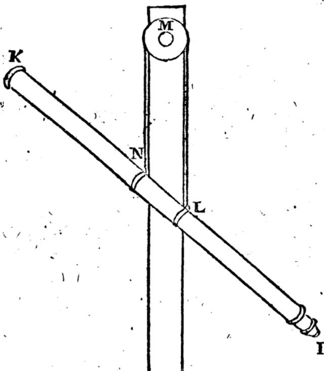
me befestiget ist. Mittelft der Rolle läßt sich das Rohr willig in vertikaler Richtung bewegen, und vermöge der Nachgiebigkeit des Seils kann es auch etwas horizontal bewegt werden. Nöthigenfalls könnte man wohl den Baum zum Umdrehen einrichten, so daß man eine freie horizontale Bewegung erhielte.
