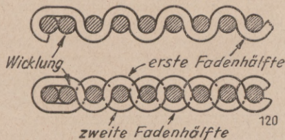
Abb. 1. Das Wicklungsschema. Oben ist erst der eine Faden, unten sind beide durchgehäht.
