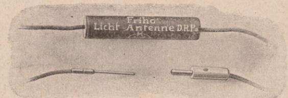
die Steckdose des Netzes ist etwa 1½ m lang, die an die Antennenklemme des Apparates zu führende etwa ½ m. Die Isolation der Antenne wurde mit 440 Volt Gleichspannung geprüft, dabei ergab sich ein Isolationsstrom von 6 Mikroampere, dies entspricht einem Isolationswiderstand von rd. 75 M $\Omega$ . Die Isolation der Lichtantenne ist somit einwandfrei.
