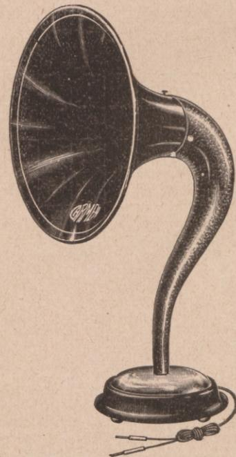
und einen größten Durchmesser von 36 cm besitzt. Als System ist eine Grawor-Lautsprecherdose verwendet, die zwei in Serie geschaltete Spulen von je 1000 Ohm besitzt. Sie enthält einen kräftigen permanenten Magneten und lamellierte Polschuhe. Die Einstellung des Systems erfolgt von unten. Die Membran ist ziemlich dick (0,35 mm); sie besitzt einen Durchmesser von 87 mm.
