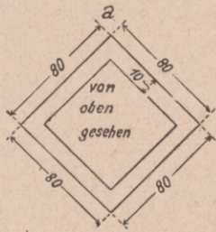
3 cm hoch für H.F. Röhre 2 cm hoch für N.F. Röhre
