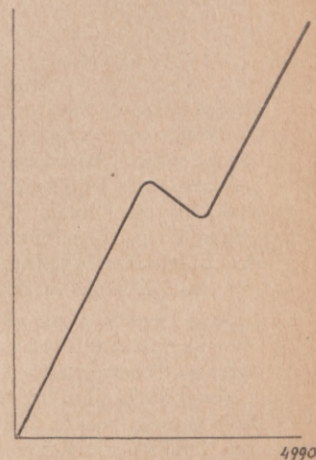
Abb. 2. Typische Charakteristik eines negativen Widerstandes.
