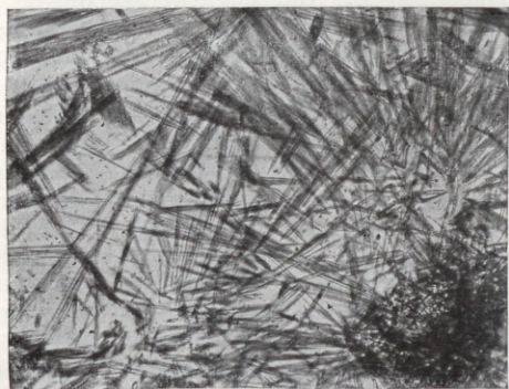
Fig. 3. \parallel Nicols roofach, 3\text{Al}_2\text{O}_3 \cdot 2\text{SiO}_2 Mullit, Bestandteil des Porzellans und anderer keramischer Erzeugnisse.
