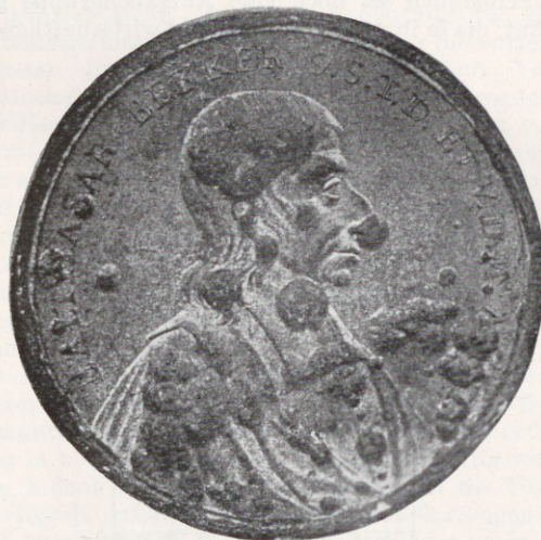
Fig. 17. Zerstörungen an einer alten Zinnmünze (Zinnpest).
