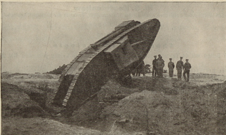
Abb. 233. Ein Tank bei etwa der höchsten Neigung.
