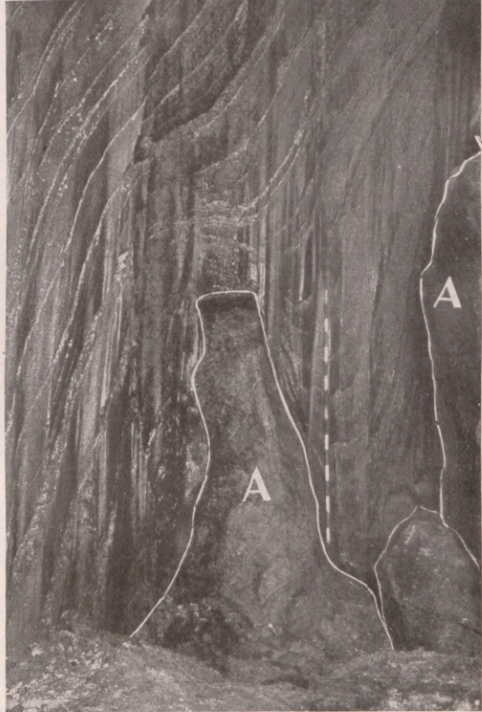
Fig. 9. Staufalten von Steinsalzmasse in der Lücke zwischen Anhydrittrümmern (A) 1) .
