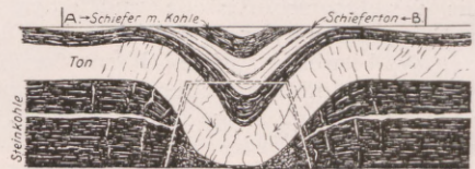
Fig. 14. Ausfüllung eines Hohraumes (verlassene Bergbaustrecke / \ /, deren ehemaliger Querschnitt) in einem Steinkohlenflöz durch Tonschichtenfalten.
