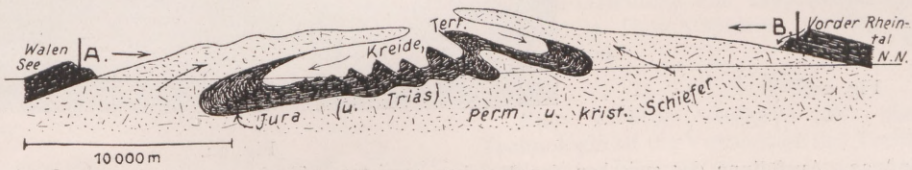
Fig. 16. Mulden zerrissener Jura- und Triasschichten zwischen übergreifenden Stau-massen des Grundgebirges. Querschnitt der „Glarner Doppelfalte“.
