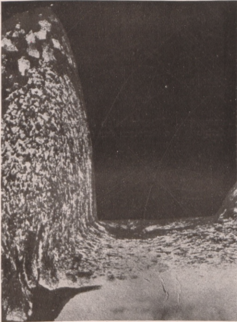
Fig. 8. Vergrößerter Ausschnitt aus dem Boden einer gepreßten Geschoßhülse (Fig. 7 b). (Vergr. 14 ×.)
