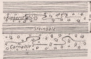
Fig. 19. Zertrümmerte Carnallitschichten und gefältete Kieseritlagen zwischen parallelen Steinsalzbänken.
