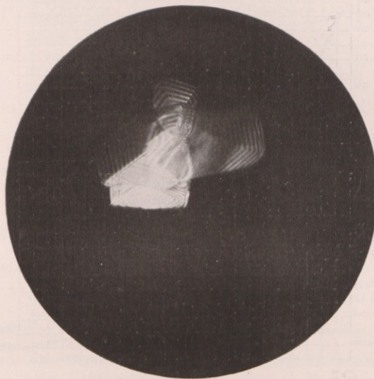
Fig. 5. Triacetylcellulose aus Tetrachloräthan; Krystallausbildung verwachsen.
