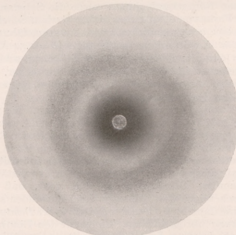
Fig. 2. Röntgenspektrum isoelektrischer, aschefreier Gelatine (ca. 50% gedehnt).
