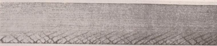
Fig. 40. Unterer Teil des in Fig. 30 dargestellten Aluminiumeinkrystallstabes mit deutlich ausgeprägten Zwillingsstreifen, stärker vergrößert. Geätzt mit Flußsäure-Salzsäure.
