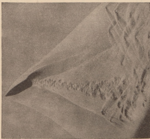
Fliegendes S-Geschoß, das durch Anstreifen an eine Holzwand absichtlich zu starken Pendelungen gebracht worden ist.
