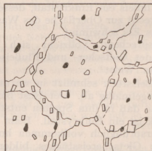
Fig. 1. Rückstand nach dem Verdampfen der Eiskrystallite.
