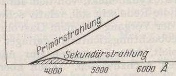
Fig. 2<sup>1</sup>. Zusammenhang zwischen der spektralen Intensitätsverteilung von Primär- und Sekundärstrahlung im Tyndalleffekt bei Erregung mit weißem Licht.
