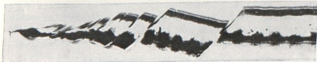
Fig. 7. Gebogene Gleitschichten an Zinn. Das Bild zeigt die Übergangsstelle zwischen Ausgangsdraht und Band, das Band selbst ist abergerissen. Vergr. 20fach.
