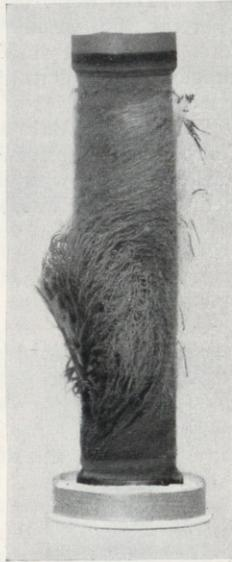
Fig. 6. Pelzartige Ausscheidung, Kohlerohr von Siemens & Co. (Seitenansicht.)
