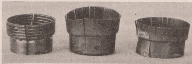
Fig. 1. Durch innere Spannungen aufgerissene Messingsockel.
