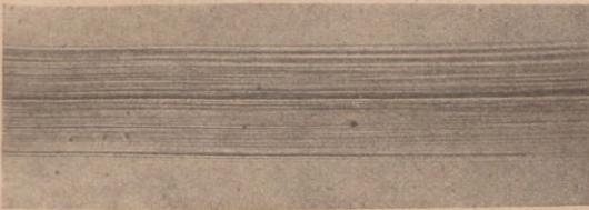
Fig. 1. Doppel-Spinnfaden eines Schmetterlings ( Attacus pernyi ) von ausgesprochen fibrillärem Bau. Vergr. 250 : 1. (Photogramm.)
