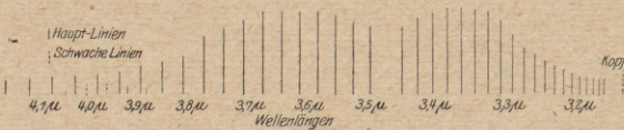
Fig. 1. Schematische Darstellung der HCl-Bande \lambda = 3,46 \mu . Die Höhe der Linien ist ein Maß für ihre Intensität.
