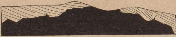
Fig. 1. Querschnitt durch den Batholithen von Marysville in Montana (nach Barrell). Der Granit (schwarz) durchschneidet die Schichten der Erdkruste und wölbt sie auf. Breite des Bildes etwa 7 km.
