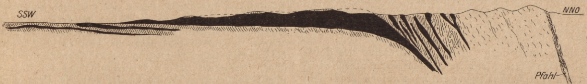
Fig. 2. Querschnitt durch einen Scheinbatholithen des Bayrischen Waldes. Granit (schwarz) stößt aus der Zone des Pfahles in mehreren flachen Platten und Zungen durch steilstehende Gneise nach SSW vor. Die tieferen Teile sind ergänzt. Das Gneißgebirge (steil gestrichelt) besteht in der Pfahlzone vorwiegend aus Eruptivgneiß, gegen SSW nehmen die Misch- und Sedimentgneise zu. (Nach Untersuchungen von R. Balk, H. und E. Cloos, H. Scholtz und H. Stenzel von August bis Oktober 1922.)
