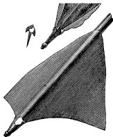
Fig. 2. Illustration zu Artikel: Pierre's Verfahren, die Schirmüberzüge auf den Gestellen zu befestigen.
