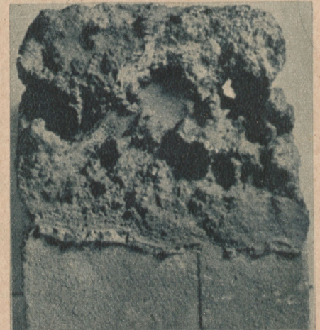
Abb. 7 Durch Schlackenangriff zerstörter Stein
