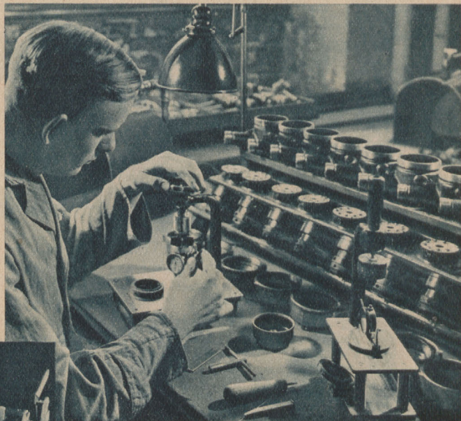
Prüfung von Wassermesser-Einzelteilen auf Maßhaltigkeit. Die Genauigkeit, mit der die in der Fabrikation benutzten Meßinstrumente messen müssen, ist genormt
