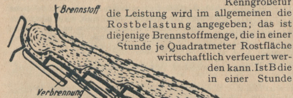
Abb. 9 Schema der Brennstoffbewegung bei einem Rückschubrost. Der Brennstoff wandert zunächst unter dem Einfluß seiner Schwerkraft nach hinten und zündet dabei unter dem Einfluß der Flammenstrahlung und der Zündkerne. Vom Rostende aus wird er durch die rückschiebenden Stufen wieder nach vorn befördert, wobei er vollständig verbrennt.
