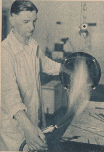
Die leicht nach außen gewölbte Schirmfläche der Braunschen Röhre darf keinerlei Unebenheiten zeigen, die den Verlauf der Kurven beeinträchtigen. Erst wenn der Kolben die richtige Form hat, wird der zylindrische Ansatz mit den Elektroden angesetzt
