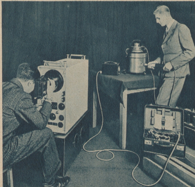
Abb. 6 Ein Staubsauger wird geprüft. Aufnahme des Körper- und Luftschalles
