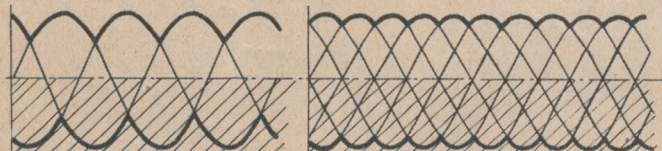
Abb. 6 Stromverlauf bei 3-Phasen-Gleichrichtung. Starke Welligkeit durch 3. Oberton
