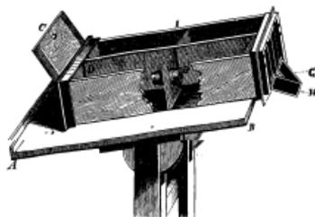
deshalb von manchen Photographen vorgezogen. — Man bedarf dazu einer langen Camera, die auf das Brett AB eines gewöhnlichen Stativs gesetzt wird. Die Camera ist der Länge nach durch die Wand DF halbrirt. An den beiden Zwischenwänden befinden sich die Objective O. An jedem Ende der Camera ist eine Cassette; in die vordere GH kommt das angefrägte Negativ, in die mit C bezeichnete die empfindliche feuchte Platte.
