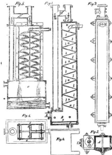
Der Apparat kann während dem Gange einer Dampfmaschine in 3 bis 4 Minuten gereinigt werden, indem man die Klappen A, H schließt, i öffnet, den Deckel abnimmt, die Schaufeln auswechseln und den Apparat wieder verschließt.
