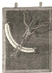
einer Spule, welche den zu prüfenden Faden enthält und läuft in ein kleines Gegengewichtsp aus, welches mit einem Sprechhaken e versehen ist, welcher in die Zähne des Gradbogens eingreift. Zum Gebrauch rollt man stets ein gleiches Ende des Fadens ab, stellt die Spule auf und zieht nun langsam und gleichmäßig, bis der Faden reißt. Der Sprechhaken hält den Zeiger auf dem Index in der erreichten Höhe fest und die Theilung gibt die Kraft, welche zum Zerreißen des Fadens
