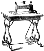
Maschine für Schuhmacher und Schneider, von mir neu construirt, mit rotirender Hebelbewegung.
