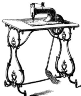
Schiffchen-Maschine nach Grover & Backer, für Tuch, Leder und Weissnäherlei, mit doppelter Uebersetzung.
