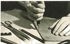
21. Mit einer Stachzähle werden die Löcher oder Schlitze eingeschnitten.
